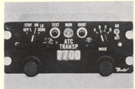
Afb. 36. Een van de eerste, geheel getransistoreerde transponders voor de straalverkeersmachine (Bendix).
