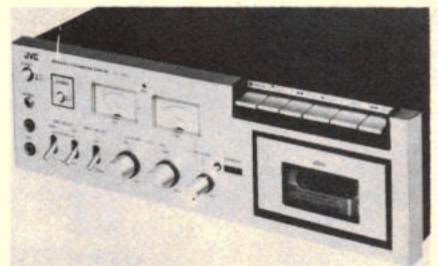
Afb. 2. JVC model CD-1950 E stereo cassette dek met ANRS ruisonderdrukking.
