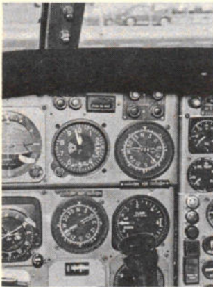
Afb. 33 en 34. Bedieningspaneel en indicatoren voor ILS, VOR, DME, ADF, COM en markers.
